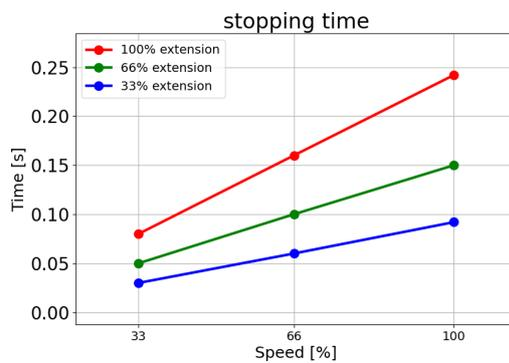
Nachlaufzeit in Sekunden bei maximaler Nutzlast von 17,5 kg
