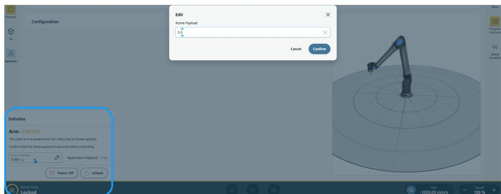
13. Tippen Sie auf die Schaltfläche **Entsperren**, um das Bremssystem des Roboterarms zu lösen.
