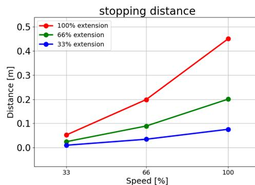
Nachlaufweg in Meter bei maximaler Nutzlast von 17,5 kg
