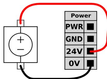
Dieses Beispiel veranschaulicht die Konfiguration mit einer externen Stromversorgung für mehr Strom.
