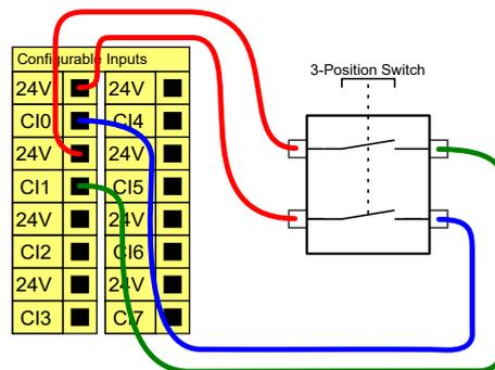
Hinweis: Die beiden Eingangskanäle für den dreistufigen Zustimmschalter haben eine Abweichungstoleranz von 1 Sekunde.
