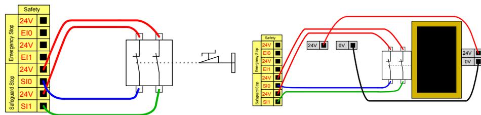
Dieses Beispiel verwendet einen Türschalter als grundlegende Sicherheitsvorrichtung, bei der der Roboter gestoppt wird, sobald die Tür geöffnet wird.
