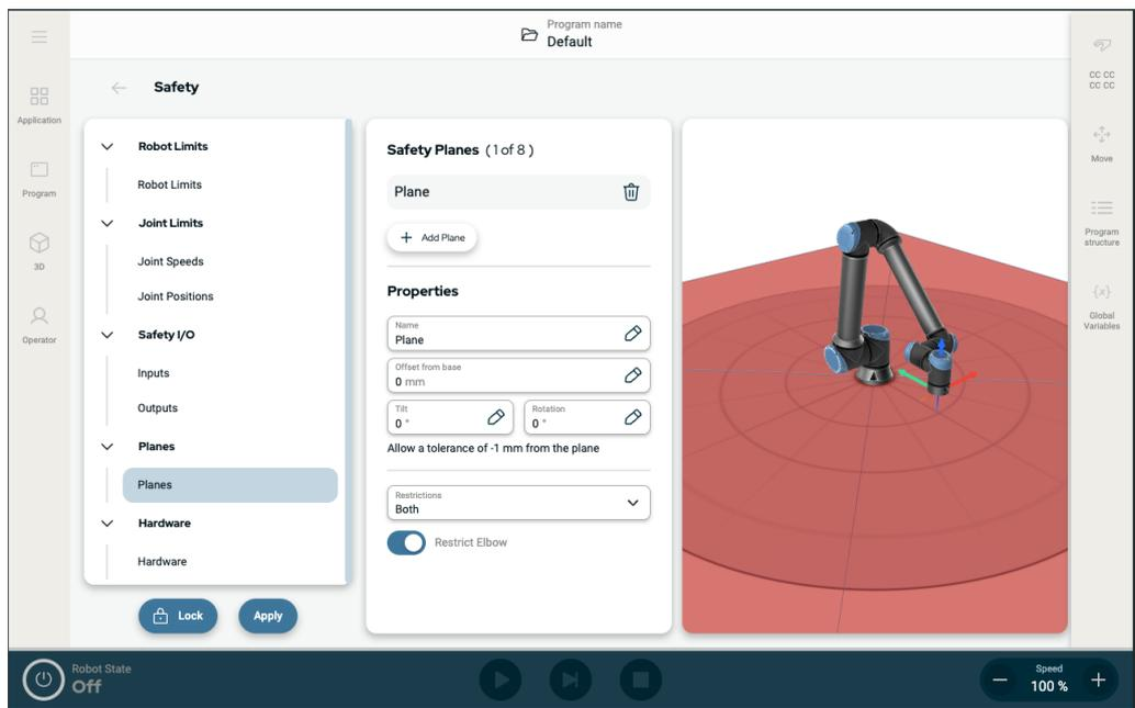
Abbildung 1.4: Bildschirm von PolyScope X, der Sicherheitsebenen anzeigt.
