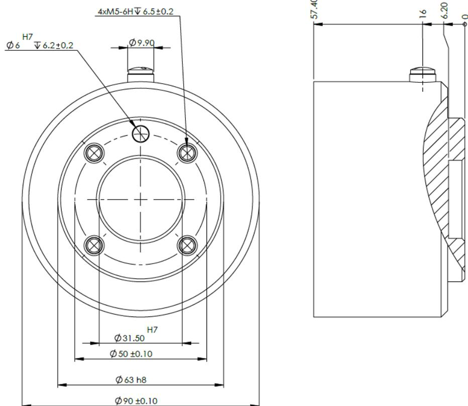
Abmessungen und ein Lochbild des Werkzeugflanschs. Alle Maße sind in Millimetern angegeben.
