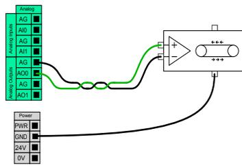
Dieses Beispiel zeigt, wie ein Fließband mit einem analogen Drehzahl-Steuerungseingang gesteuert werden kann.
