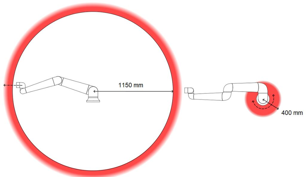
*Aufgrund der physikalischen Eigenschaften des Roboterarms erfordern bestimmte Arbeitsbereiche besondere Aufmerksamkeit wegen Quetschgefahr. Dazu gehört ein Bereich (links) bei radialen Bewegungen, wenn das Handgelenk 1 mindestens 1150 mm von der Basis des Roboters entfernt ist. Der andere Bereich (rechts) befindet sich bei Tangentialbewegung innerhalb von 400 mm von der Basis des Roboters.*
