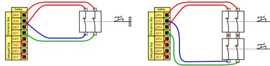
**Notabschaltung mit mehreren Maschinen teilen**
