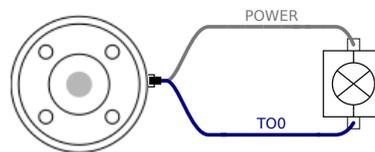
Es wird empfohlen, eine Schutzdiode für induktive Lasten zu verwenden (s. unten).
