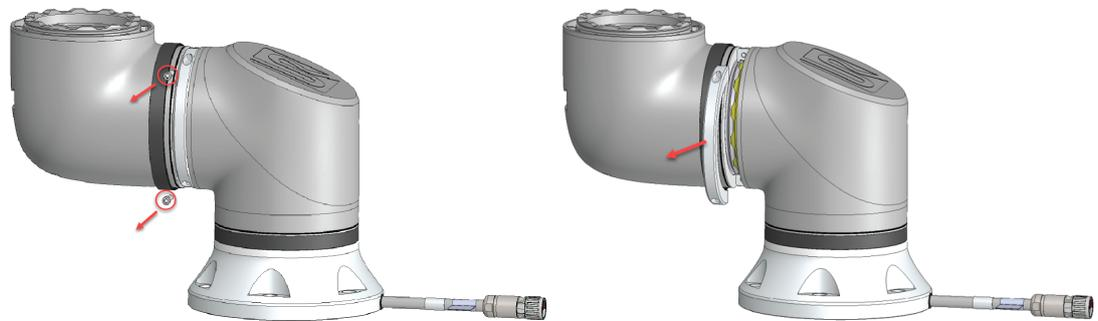
4. Stützen Sie das Gelenk ab, während Sie die zweite Seite der Klemme entfernen.
