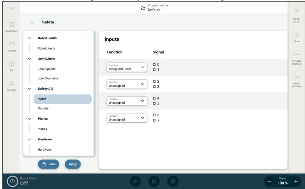
Abbildung 1.3: Bildschirm von PolyScope X, der Eingangssignale anzeigt.
