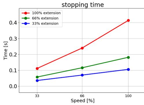
Nachlaufzeit in Sekunden bei maximaler Nutzlast von 17,5 kg
